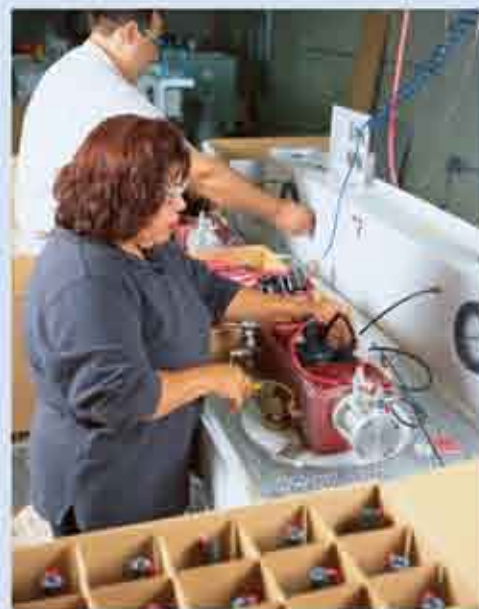
Para lograr los mayores niveles de control de calidad, Hunter realiza pruebas de agua rutinarias al 100 por cien de todos los modelos de electroválvulas a presiones y caudales máximos y mínimos.
