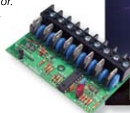
Los MOV protegen los componentes electrónicos del ICC contra las sobretensiones tan perjudiciales.
